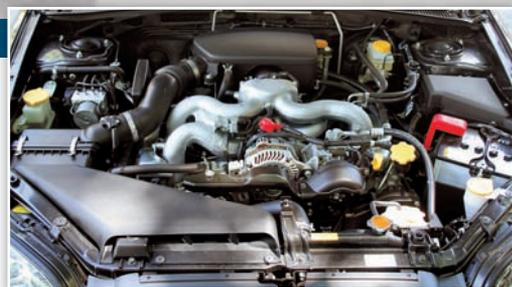
**М**ощность 2,0-литрового двигателя уменьшилась на 15 л. с., зато крутящий момент вырос на 9 Нм. Максимальная скорость машины с МКП снизилась на 5 км/ч, но мотор позволяет экономить от 0,4 до 1,1 л топлива в зависимости от типа трансмиссии и режима движения.
