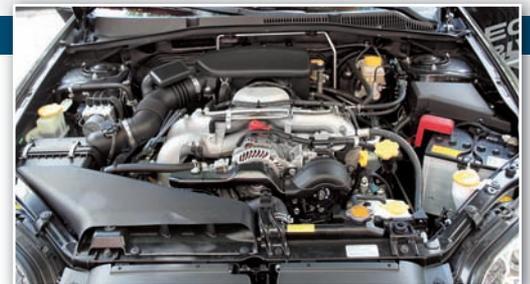
**Д**вигатель объемом 2,5 литра теперь на 8 л. с. мощнее и на 1 Нм тяговитее. Скорость седана выросла на 21 км/ч (с МКПП) и на 20 км/ч (с АКПП). Улучшилась и динамика: у версии с «механикой» – на 0,5 с, с «автоматом» – на 0,1 с при небольшом выигрыше в экономии.
