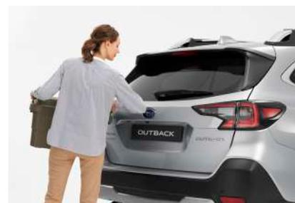
Кришка багажного відсіку з електроприводом і функцією безконтактного відкриття
